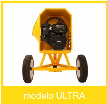
Revolvedora para concreto marca: CIPSA mod. Ultra-10, capacidad de un saco, tipo trompo, olla de metal, volumen de la olla 350 lts, capacidad de mezcla 255 lts, producción 5m<sup>3</sup>/hr, ciclo de producción 3 min. La revolvedora es uno de los producto de mayor calidad del mercado. Con un sistema único remolcable para facilitar su movimiento de obra. La olla de acero es fabricada en dos piezas (un sólo cordón de soldadura). Tiene refacciones totalmente intercambiables.
