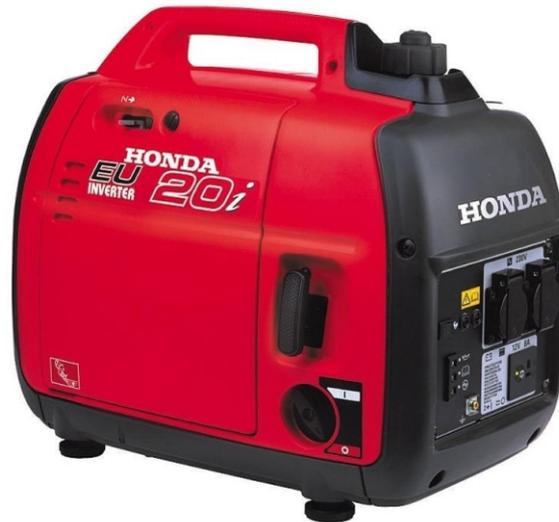
Generador monofásico de 2 Kva, salida de 220 V en corriente alterna y 12 V en corriente continua, insonorizado y de muy bajo consumo (10 horas de operación en modo ECO-THROTTLE). De fácil arranque, sólo emite 59 dB a 7 metros a plena carga, que es menos que el ruido provocado por una conversación. La tecnología Honda Inverter lo hace ideal para el uso en equipos electrónicos debido a su onda senoidal uniforme.
