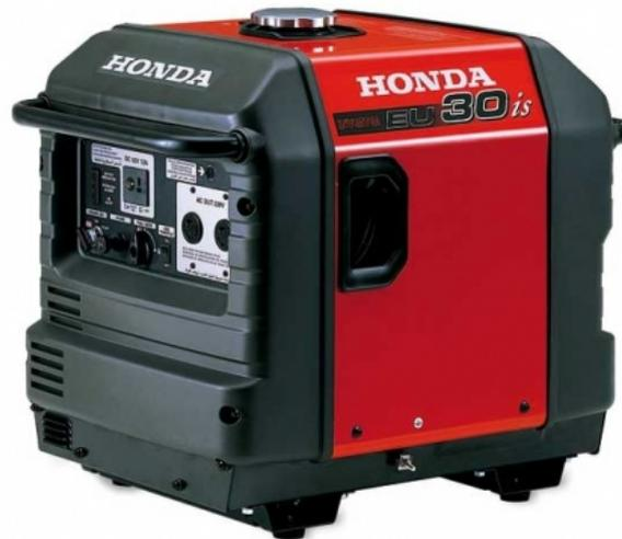
Este generador apenas emite 58 dB, que es menos que el ruido producido por dos personas conversando, y puede operar durante 20 horas en su modo ECO-THROTTLE. Produce 3000 watts y pesa sólo 59 kg. La tecnología Honda Invertir hace que este equipo sea ideal para el uso en equipos electrónicos, debido a su onda sinusoidal uniforme.
